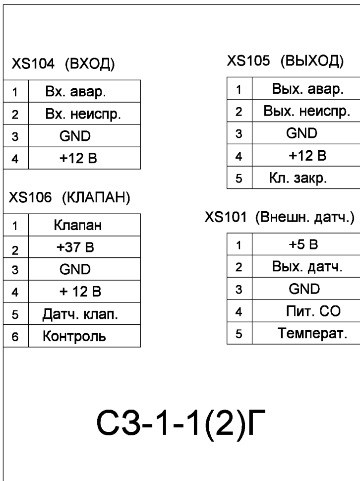
Рисунок Б - Схема внешних соединений сигнализатора
